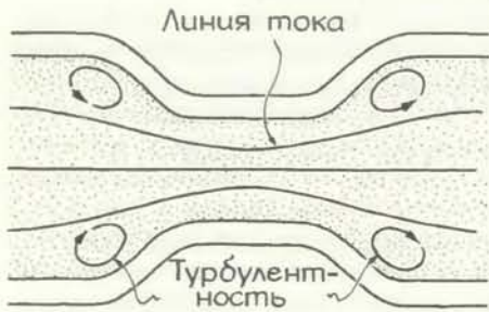
Турбулентность в месте сужения трубы
